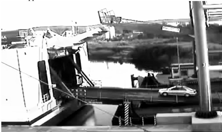
Fig. 1. Dangerous close proximity of the ferry ramp with the approach bank Rys. 1. Niebezpieczne zbliżenie ramy promu do pomostu
